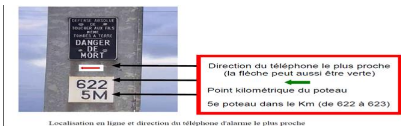
Localisation en ligne et direction du téléphone d'alarme le plus proche
